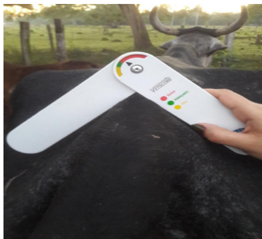
Figura 2. Dispositivo VETSCORE® para medir la condición corporal (CC) en bovinos: vista frontal posterior de una vaca.
